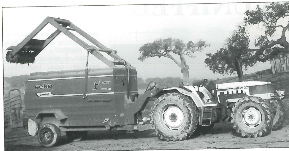
Na Sociedade David, em Ourique, um Unifed Seko de 12 t, com desensilador e balança electrónica, permite distribuir diariamente 3.000 kg de alimentos para mais de 150 animais em três formulações diferentes. Esta operação requer um único homem durante 2 horas, sendo a máquina accionada por um tractor de 90 Hp.
