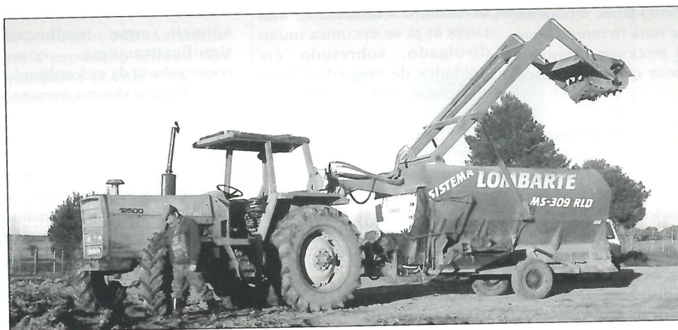
No Monte Cailogo Rui Borges de Sousa utiliza uma máquina Uniffide Lombart de 7,5 t, equipada com fresa autocarregadora.
